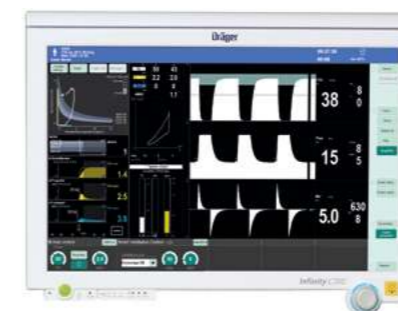
Дисплей с активным экраном высокого разрешения. Полоса визуальной индикации тревоги с обзором 360°.
