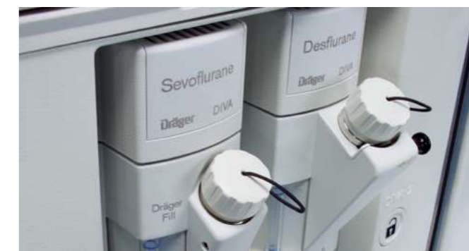
Электронное управление дозированием анестетика. Инжекторный принцип действия испарителя – прямой впрыск анестетика в контур вне потока свежего газа.
